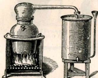
Alambic-brûleur pour la distillation simple des matières pâteuses, marcs et lies.
